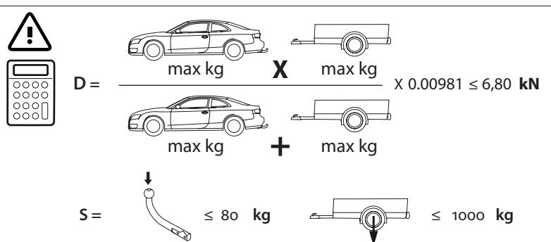
Regarder les caractéristiques techniques du véhicule ou prendre contact avec votre concession pour vérifier le poids tractable max. du véhicule!
