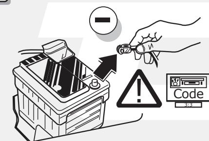
(DE) Um Störungen und Schäden am Bordnetz zu vermeiden, muss die Massepolklemme unbedingt vor Beginn aller Arbeiten von der Fahrzeugbatterie getrennt werden! Insbesondere bei Arbeiten und Anschlüssen am CAN-Datenbus kann bei nicht abgeklemmter Batterie sowohl das Anhängermodul als auch das fahrzeugeigene Bordnetzsteuergerät beschädigt werden! Bitte Herstellervorschriften beim Ab- und Anklemmen der Fahrzeugbatterie beachten!
